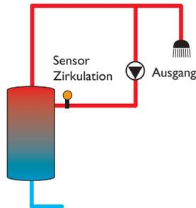
Die **Zirkulationsfunktion** dient zur Regelung und Ansteuerung einer Zirkulationspumpe.
