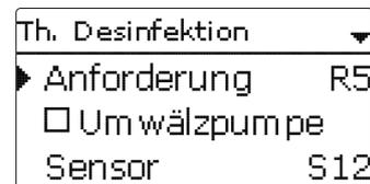
Diese Funktion dient dazu, die Legionellenbildung in Trinkwasserspeichern durch gezielte Aktivierung der Nachheizung einzudämmen.
