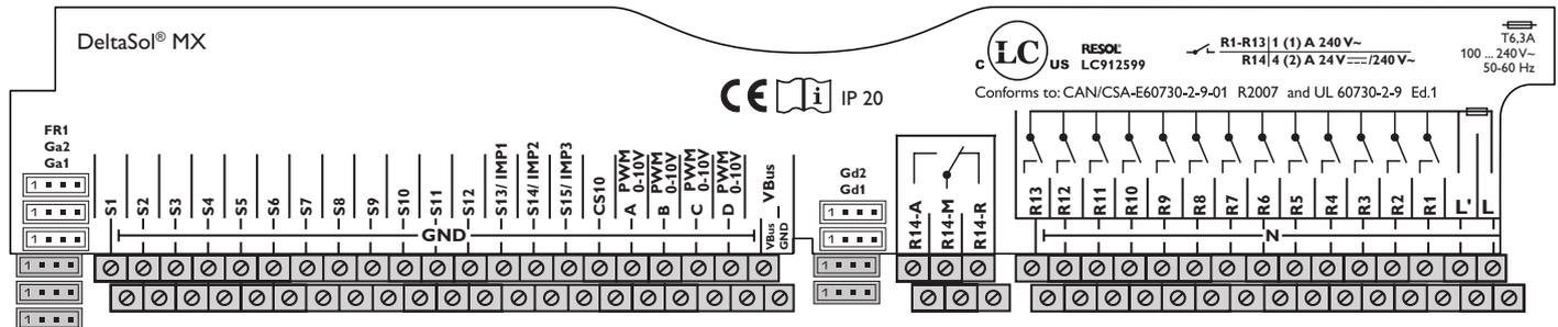
Den Einstrahlungssensor **CS10** unter Beachtung der Polung an die Klemmen CS10 und GND anschließen. Dazu den am Sensor mit GND gekennzeichneten Anschluss mit dem Masse-Sammelklemmenblock GND, den mit CS gekennzeichneten Anschluss mit der Klemme CS10 verbinden.
