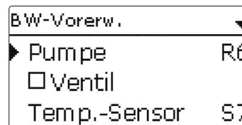
Die **Brauchwasser-Vorerwärmung** dient dazu, mit Wärme aus einem Pufferspeicher den Kaltwasserzulauf des Brauchwasserspeichers zu erwärmen.
