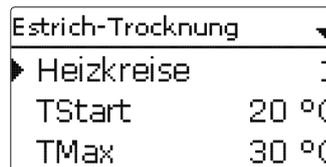
Der Regler springt in das Statusmenü der Estrich-Trocknung. Die aktuelle **Phase** wird im Display angezeigt und die **Restzeit** wird heruntergezählt (dd:hh). Während dieses Vorganges blinkt das Tastenkreuz grün.
