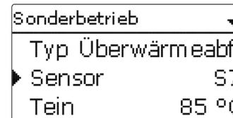
Die Variante **Überwärmeabfuhr** dient dazu, überflüssige Wärme in den Heizkreis abzuführen, um die Systemtemperatur im Betriebsbereich zu halten. Dazu wird die Temperatur am zugewiesenen **Sensor** überwacht. Wenn die Temperatur am zugewiesenen Sensor die **Einschaltemperatur** überschreitet, wird die **Vorlaufsollltemperatur** auf den eingestellten Wert geregelt. Wenn die Temperatur am zugewiesenen Sensor die **Ausschaltemperatur** unterschreitet, wird die Überwärmeabfuhr inaktiv.
