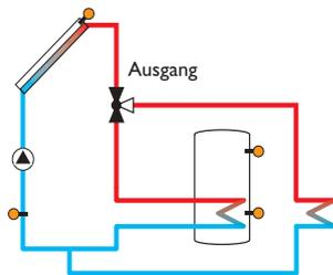
Die **Überwärmeabfuhr** dient dazu, im Falle starker Sonneneinstrahlung die entstehende überflüssige Wärme zu einem externen Wärmetauscher (z. B. Fan Coil) abzuführen, um die Kollektortemperatur im Betriebsbereich zu halten.
