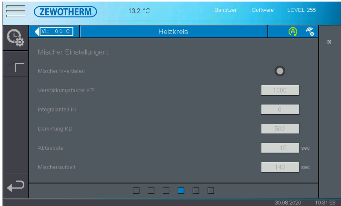
Heizkreis Einstellungen Seite 4 (Mischereinstellungen)
